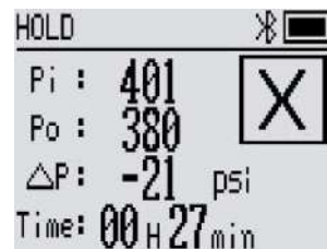
Imagen 5 - Falla en la prueba
