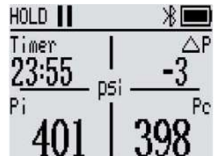
Imagen 3 - Interfaz de la prueba de estanqueidad
