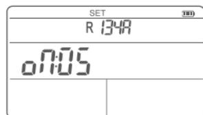
Figura 10 Pantalla de desconexión automática
