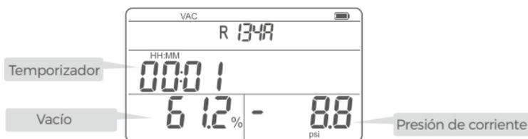
Fig. 4 Interfaz de prueba de vacío
