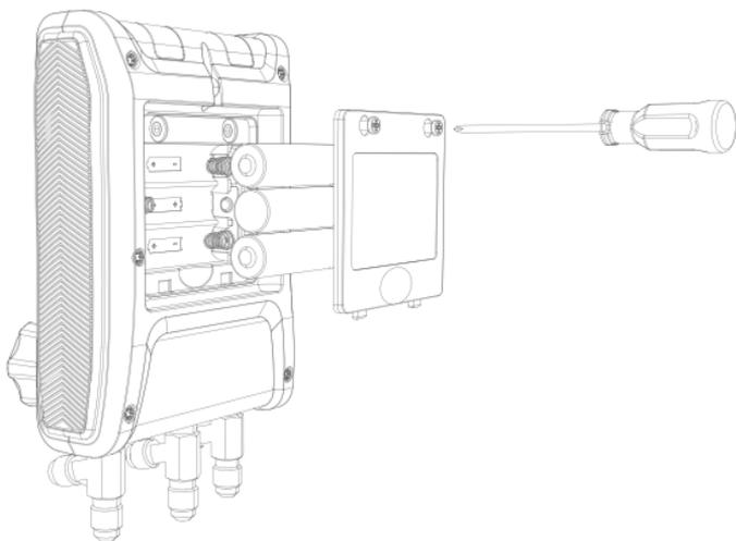
3. Retire la pila vacía y llene el compartimento de la pila con una nueva.
